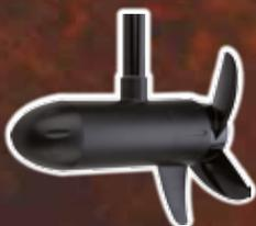
Zuverlässige untere Einheit aus massivem Stahl und Aluminium aufgebaut mit einer Pulverbeschichtung.
